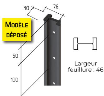
Poteau avec perçages en fond de feuillure permettant la fixation du panneau par vis à bois (non fournis).
