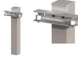
Poteau guide avec équerre anti-soulèvement •Selon portail •Laquée à la couleur du portail •100x100 mm •A sceller
