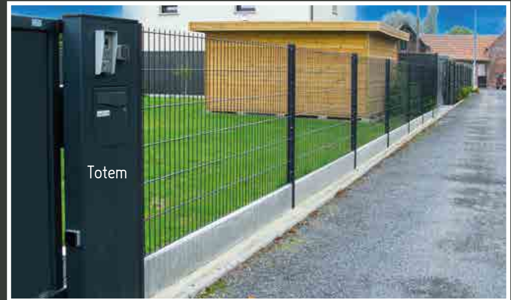
Panneaux Bifils (Plan) avec soubassement plaques béton
